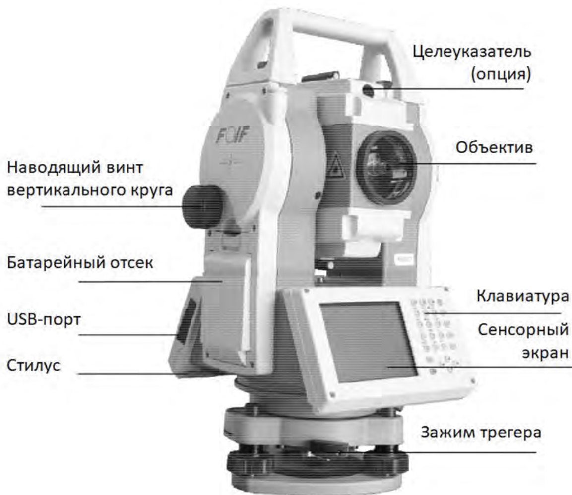
Рисунок 3 - Основные элементы тахеометра RTS362
