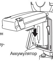
3. Закройте крышку отсека. При фиксации крышки раздается характерный щелчок.
