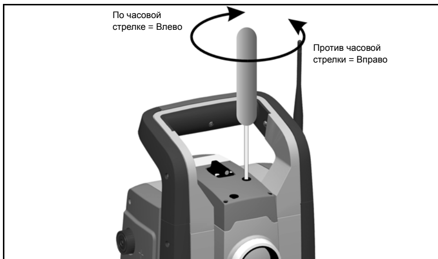
Рис. 4.33. Юстировка горизонтального положения
