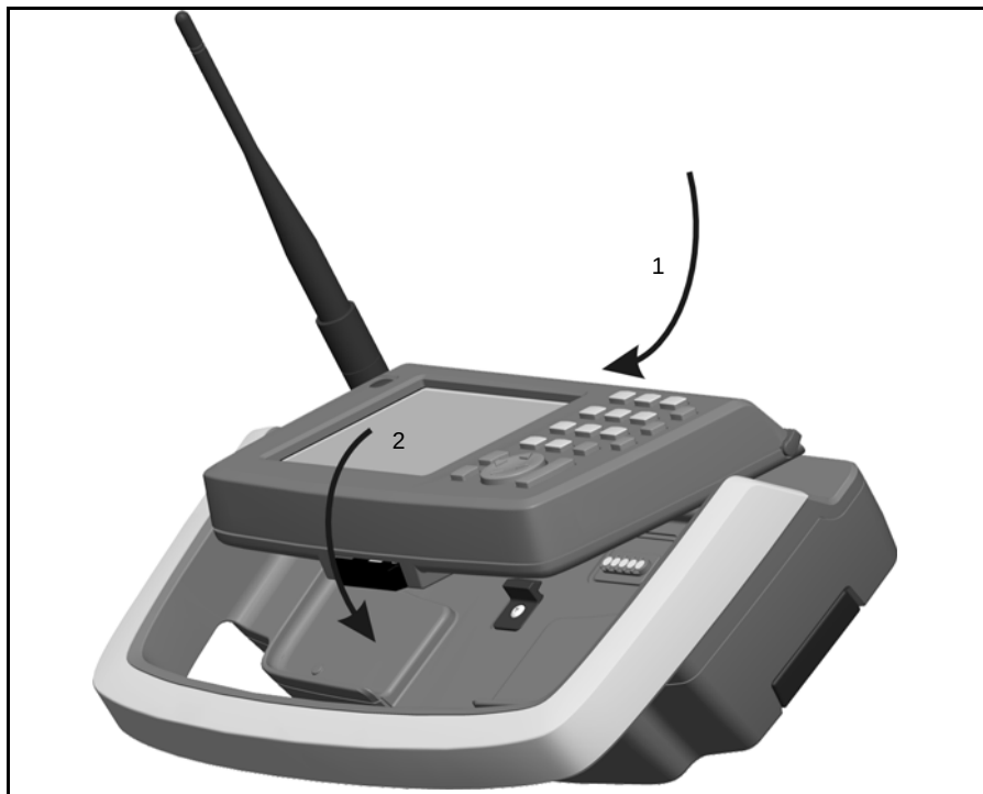
Рис. 7.72. Подсоединение контроллера Trimble CU к держателю Trimble Robotic
