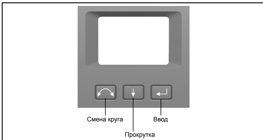
Рис. 3.17. Клавиатура и дисплей круга 2
