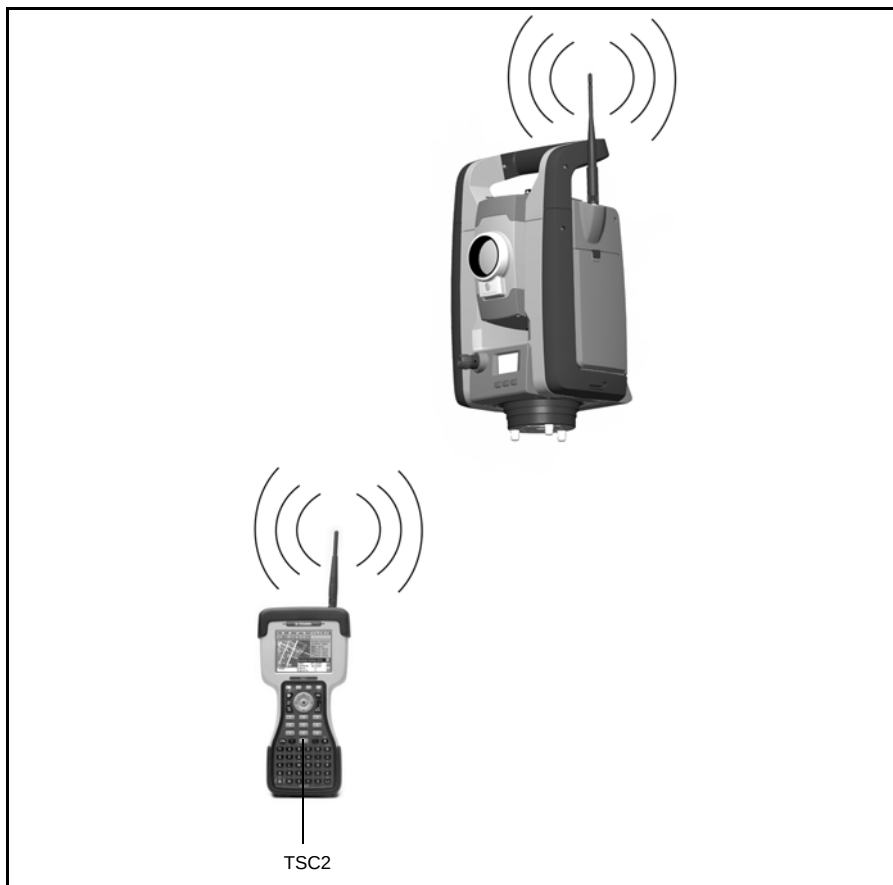
Рис. 4.43. TSC2 подключается к тахеометру Trimble S8 с помощью встроенного радиомодема для измерений в режиме Robotic.
