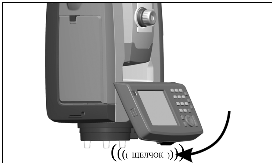
Рис. 4.38. Установка контроллера Trimble CU
