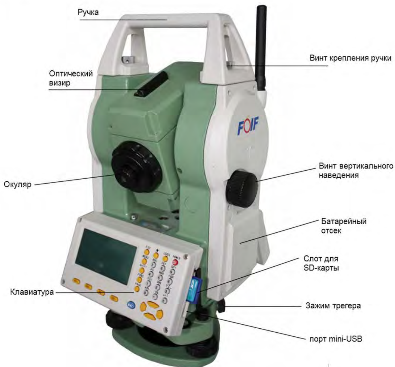
Рисунок 3 - Основные элементы тахеометра RTS332 (задняя часть)
