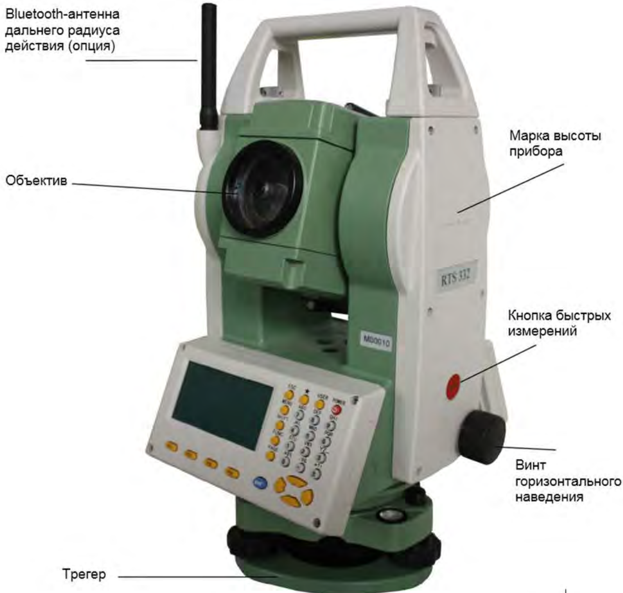
Рисунок 4 - Основные элементы тахеометра RTS332 (передняя часть)
