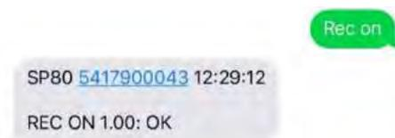
**Пример 18:** Включение записи сырых данных с установкой интервала записи (в секундах):
