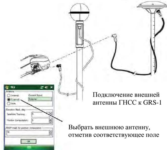
Рис. 3-6. Подключение антенны PG-A1/PG-A5/MG-A8 к GRS-1
