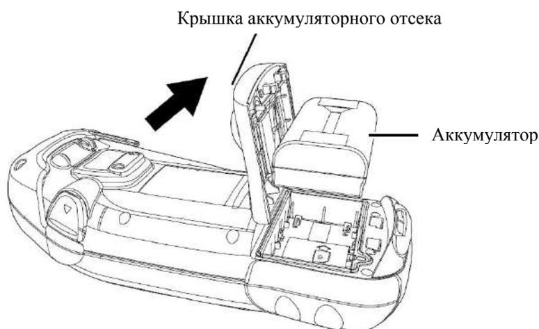
Рис. 2-2 Установка основного аккумулятора
