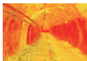
Облака точек тоннелей угольных шахт
