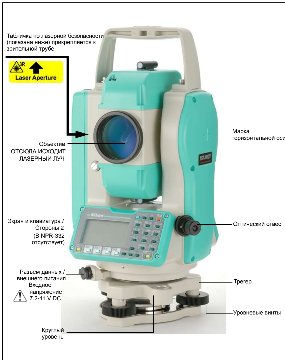
Рисунок 1.2 Электронный безотражательный тахеометр серии NPR-302 – Сторона-2
