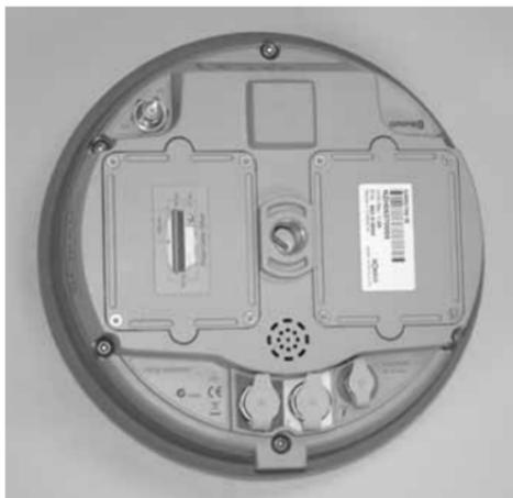
Низ корпуса GSR2700 IS/ISX имеет стандартную втулку 5/8", совместимую со стандартным креплением quick release для установки приемника на штатив или вешку. Втулка вмещает винт длиной 0,75" (19 мм).
