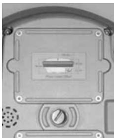
Встроенная антенна для устройства беспроводной связи Bluetooth обозначена на нижней части корпуса квадратом (см. Рисунок 7).
