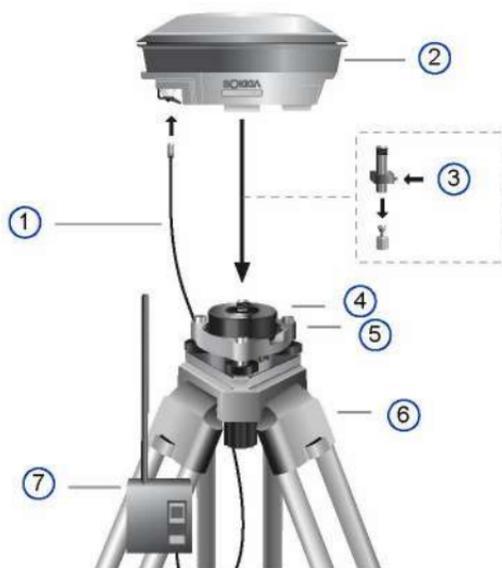
**Таблица 20: Компоненты установки RTK базы (внешнее радио)**
