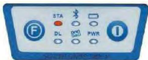
**STA** : в статическом режиме показывает, что ведется запись данных. В режиме RTK, что модуль передачи данных находится в рабочем состоянии;
