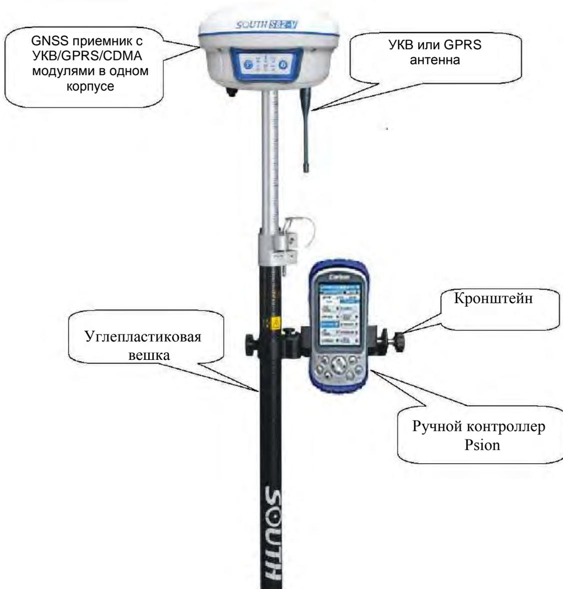
Рисунок 1.1 – Комплект роверного GNSS RTK приемника S82V
