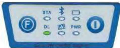
**DL** : индикатор светится зеленым цветом в режиме RTK, если работает GPRS канал передачи данных.
