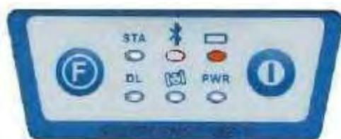
Питание прибора осуществляется от встроенных аккумуляторов. Постоянный свет индикатора показывает, что аккумуляторы заряжены. Мигающий индикатор предупреждает, что заряд аккумулятора заканчивается;
