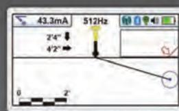
Режим отображения вектора – трехмерное отображение ориентации, положения и расстояния до коммуникации
