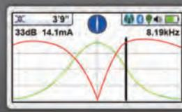
Поперечная схема или Мин/макс режим – отображение максимума и минимума для сравнения формы искажения
