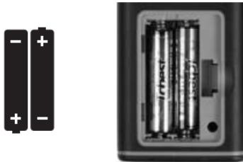
Откройте крышку батарейного отсека на задней части прибора, вставьте батареи, соблюдая полярность, затем закройте крышку.
