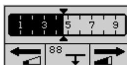
Теперь чувствительность приёмника нажатием кнопки [1] будет уменьшаться на один процент и нажатием кнопки [3] увеличиваться на один процент. Продолжительное нажатие на соответствующую кнопку ускоряет процесс.
