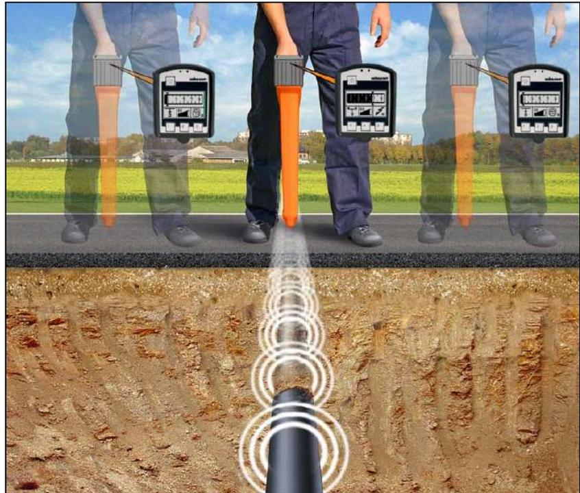
Ориентация приёмника по отношению к линии простираения проводника, в зависимости от расположения антенн, оказывает следующее влияние на мощность принимаемого сигнала:
