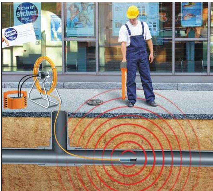
Допускается также локализация активных зондов (напр. зонды с видеокамерой) подходящей частоты (32,768 kHz) с помощью приемника. Для детальных указаний по способу действий необходимо наличие руководства по эксплуатации применяемых продуктов.
