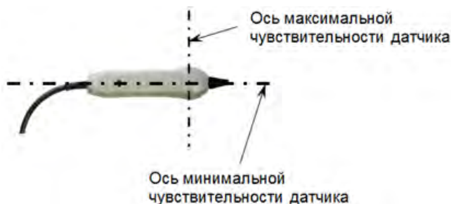
Рисунок А.2. Оси чувствительности датчика MED-127.
