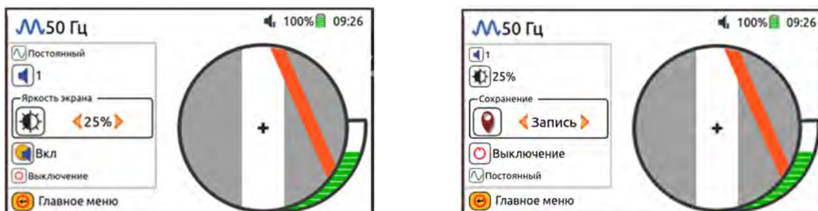
Рисунок 4.3. «Быстрое меню» приемников АП-019.4 и АП-019.5.
