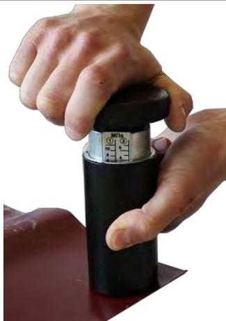
Рисунок 2.6 – Взвод пружины поворотного механизма
