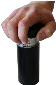
Рисунок 2.4 – Процесс отпущения захватного механизма
