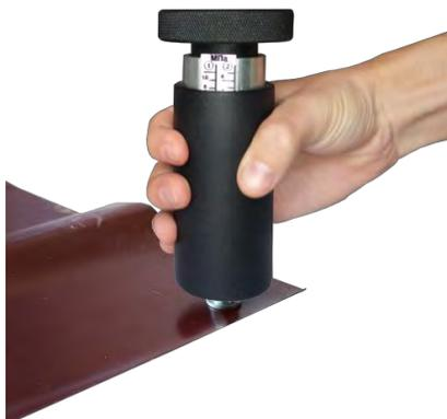
Рисунок 2.5 – Процесс наворачивания механизма на грибок
