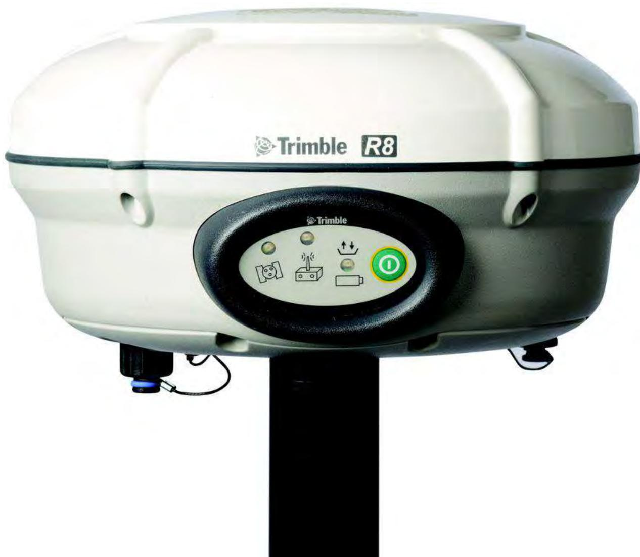
Кнопка Питание позволяет включать и выключать приёмник.
