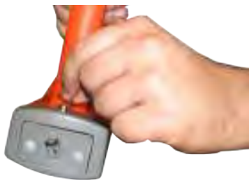
а) Выдвинуть фиксатор, освободить батарейный отсек
