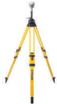
Базовый приемник с выносной УКВ антенной в режиме реального времени
