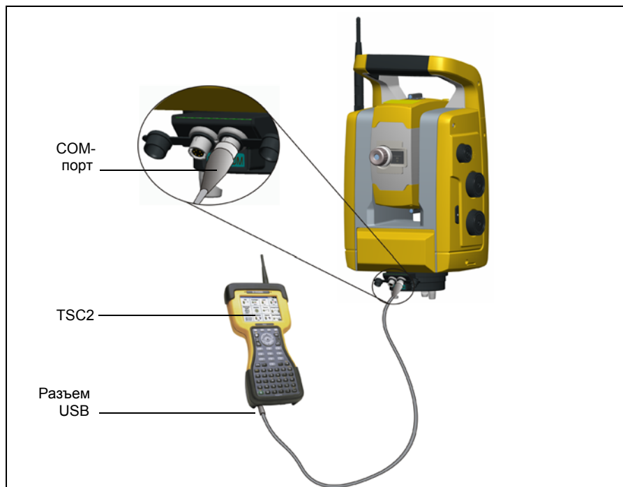
Рис. 4.27. Контроллер TSC2, подключенный к тахеометру Trimble S3 Robotic с помощью кабеля для измерений в режимах Servo и Autolock
