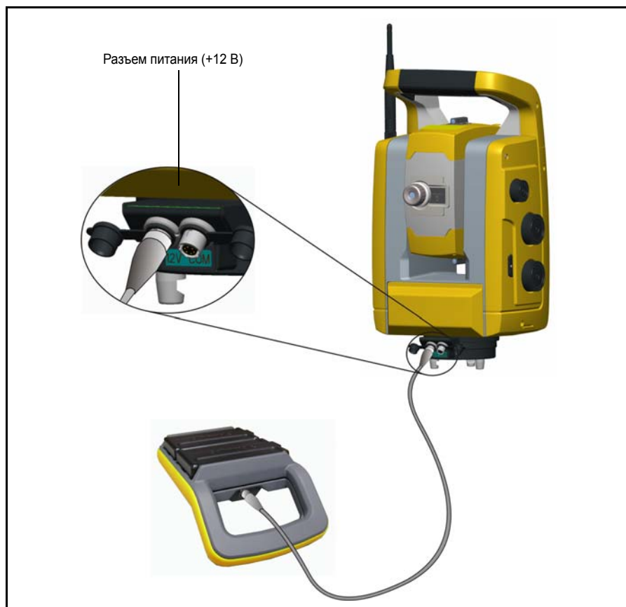
Рис. 3.16. Подключение адаптера для нескольких батарей
