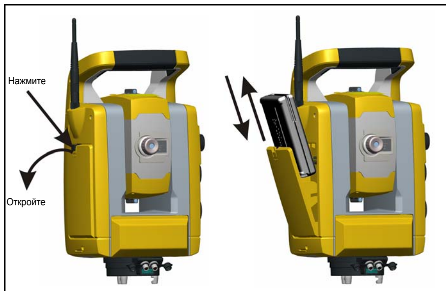
Рис. 3.14. Извлечение и замена внутренней батареи
