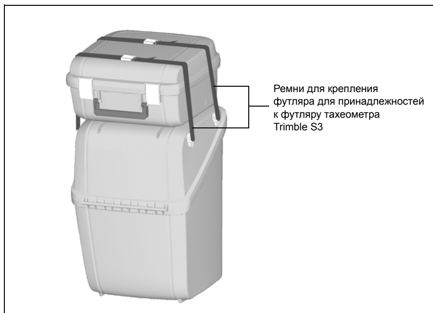
Рис. 6.51. Футляр для принадлежностей, закрепленный на футляре для тахеометра Trimble S3
