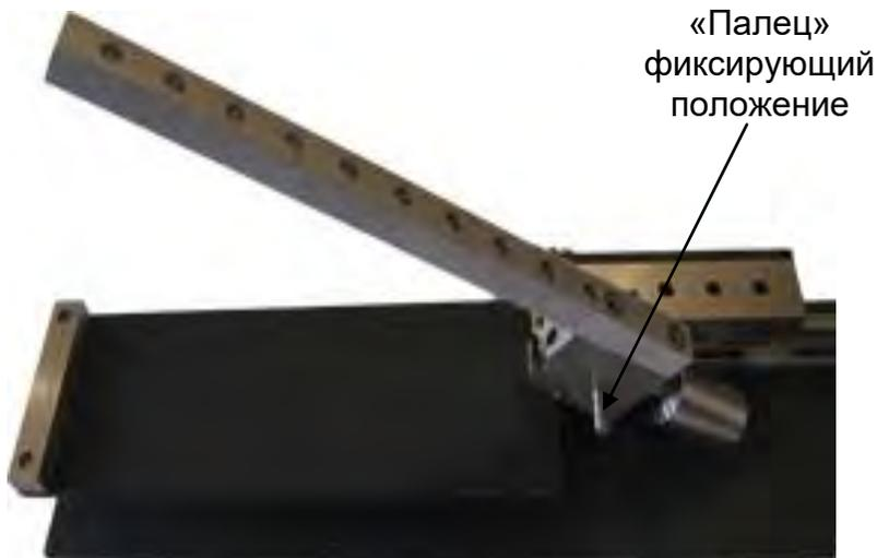
Установите прибор в положение для смены индентора. Раскрутите фиксирующие болты, установите индентор (до упора), закрутите фиксирующие болты.
