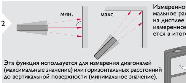
Измеренное минимальное и максимальное расстояние отображается на дисплее (мин, макс). Последнее измеренное расстояние отображается в итоговой строке.
