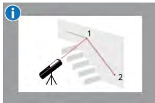
Промежуточное расстояние рассчитывается на основе двух известных координат с помощью значений x, у и z.
