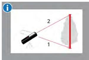
Высота рассчитывается по тригонометрическим функциям с помощью одной известной длины и одного измеренного угла.
