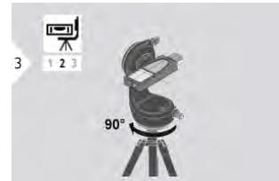
Поверните прибор по направлению движения часовой стрелки на  $90^\circ$ . Следуйте инструкциям на дисплее.
