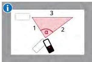
Угол рассчитывается по теореме косинусов посредством трех известных сторон треугольника.
