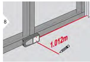
8 Медленно перемещайте прибор вдоль линии разметки. На дисплее отобразится расстояние до следующей точки разметки.
