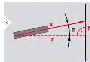
Горизонтальное расстояние рассчитывается по тригонометрической функции косинуса с помощью одной известной длины и одного известного угла.
