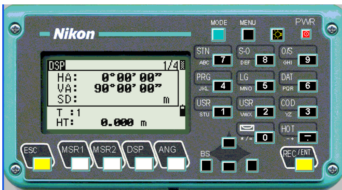
Рисунок 3.1 Клавиатура и дисплей NPL-302.
