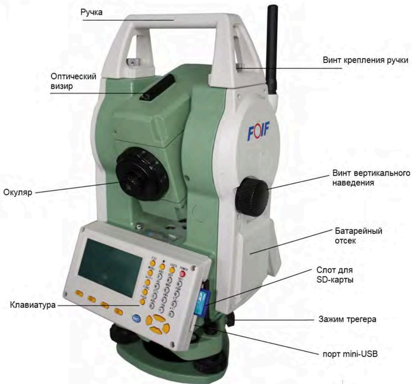
Рисунок 3 - Основные элементы тахеометра RTS332 (задняя часть)
