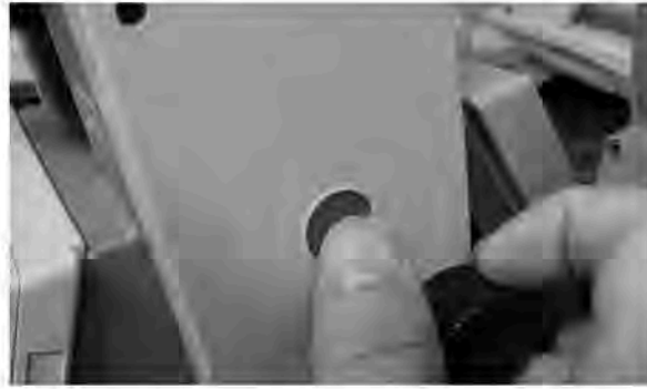
Рисунок 6 – Кнопка быстрых измерений тахеометра RTS332
