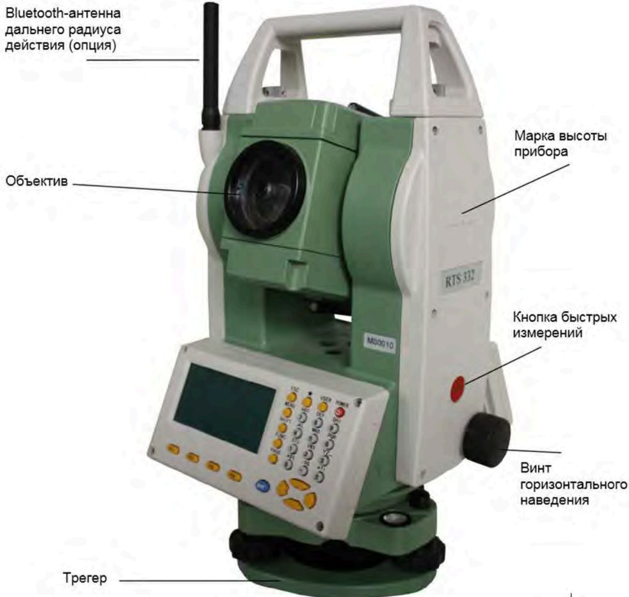
Рисунок 4 - Основные элементы тахеометра RTS332 (передняя часть)
