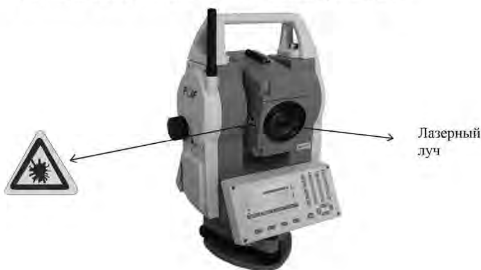
Рисунок 1 – Наклейки с оповещением об опасности лазерного излучения
