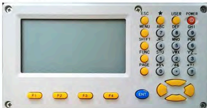
Рисунок 5 – Экран и клавиатура тахеометра RTS332
