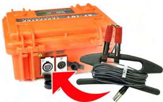
1.12.2. Один из зажимов кабеля подключается к исследуемой коммуникации, а второй к штырю заземления (или к подходящему заземлению) максимально далеко от коммуникации. Противоположный конец исследуемой коммуникации
