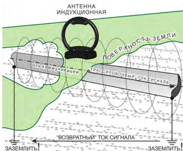
**Если используется внешняя индукционная передающая антенна «АН», то следует расположить ее как можно ближе к исследуемой коммуникации и в одной плоскости с ней. Не следует пользоваться трассоискателем вблизи расположения передающей антенны во избежание непосредственной индукционной связи (помимо коммуникации).**
