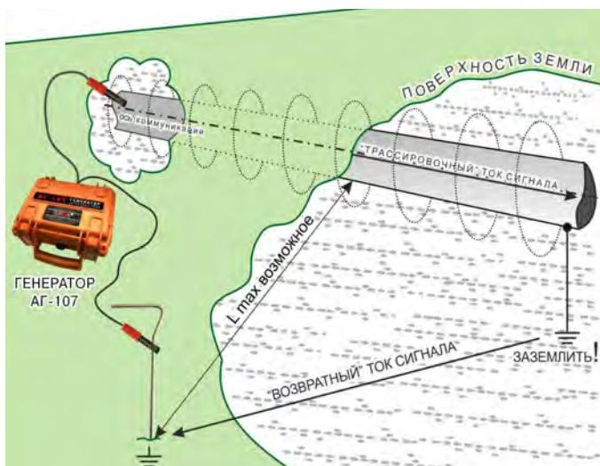
Противоположный конец исследуемой коммуникации следует заземлить для создания пути протекания «возвратного» тока сигнала.
