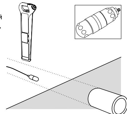
появляются слабые паразитные сигналы. Определите места всех трех пиковых значений сигнала, чтобы по самому сильному среднему сигналу определить место нахождения «зонда».
