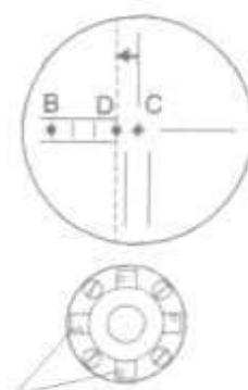
3. Поворачивая регулировочные воротки в верхней, нижней и стопорных винтах окуляра передвиньте вертикальную нить сетки нитей т.о. чтобы она совпадала с точкой D. По окончании регулировки повторите процедуру поверки. Если точки B и C совпадают, то дальнейшей регулировки не требуется. В противном случае повторите регулировку.
