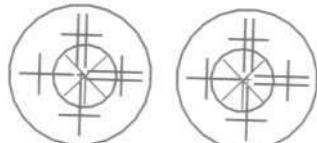
1. Поворачивая регулятор фокуса сетки нитей отрегулируйте резкость так, чтобы сетка нитей была чётко видна.
