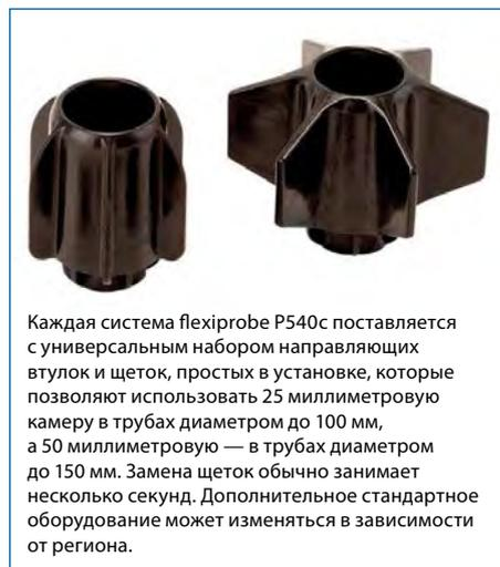
Каждая система flexiprobe P540c поставляется с универсальным набором направляющих втулок и щеток, простых в установке, которые позволяют использовать 25 миллиметровую камеру в трубах диаметром до 100 мм, а 50 миллиметровую — в трубах диаметром до 150 мм. Замена щеток обычно занимает несколько секунд. Дополнительное стандартное оборудование может изменяться в зависимости от региона.
