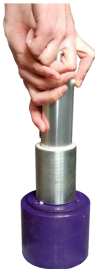
Рисунок 2.1 – Проверка молотка Шмидта на эталонной наковальне
