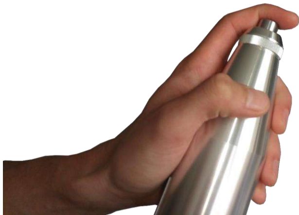
Рисунок 2.3 – Освобождение ударного плунжера
