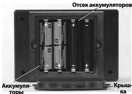
Рис. 6 – Замена аккумуляторов (передатчик)
