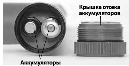
Рис. 7 – Замена аккумуляторов (приемник)
