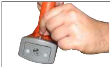
а) Выдвинуть фиксатор освободить батарейный отсек
