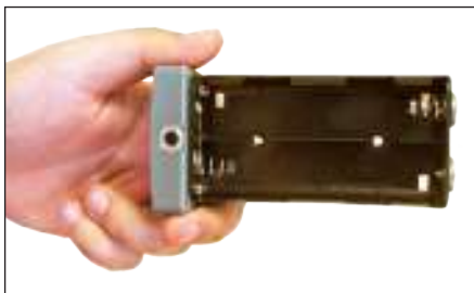
б) Вставить батареи в отсек, соблюдая полярность
