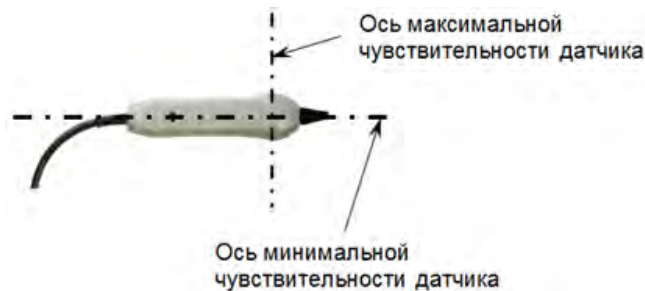
Рисунок А.2. Оси чувствительности датчика MED-127.
