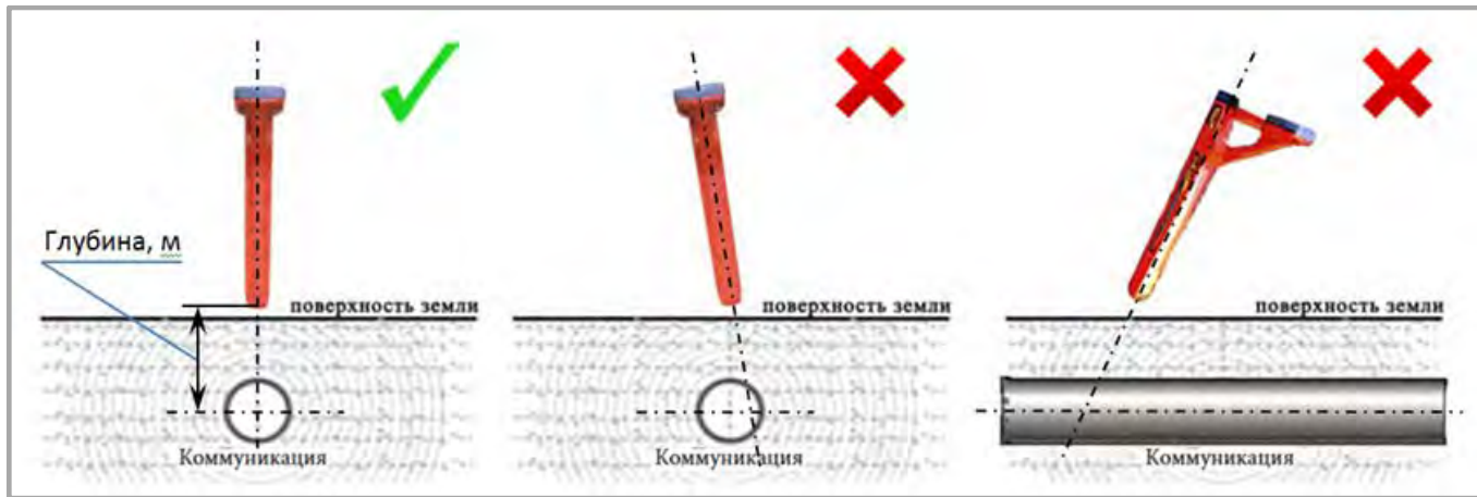
Рисунок 3.6. Правильное положение приемника при замере глубины.
