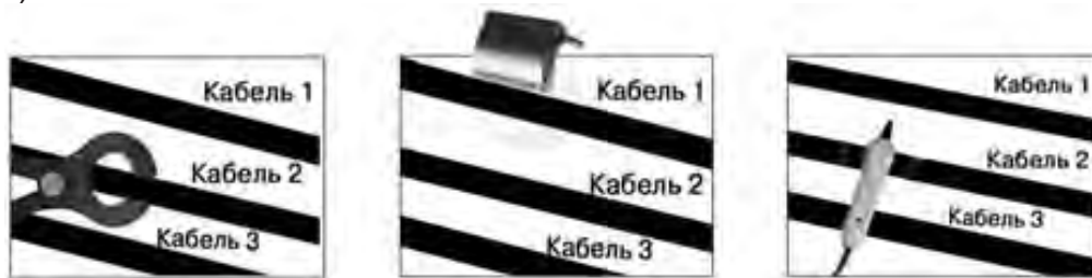
Рисунок А.1. Выбор кабеля из пучка внешними датчиками.
