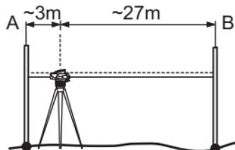
**Шаг 3:** направьте объектив на рейку В и нажмите клавишу ИЗМЕРЕНИЕ. Отображение измерения, для того чтобы принять, нажмите и удерживайте нажатой клавишу измерения в течение 3 секунд.
