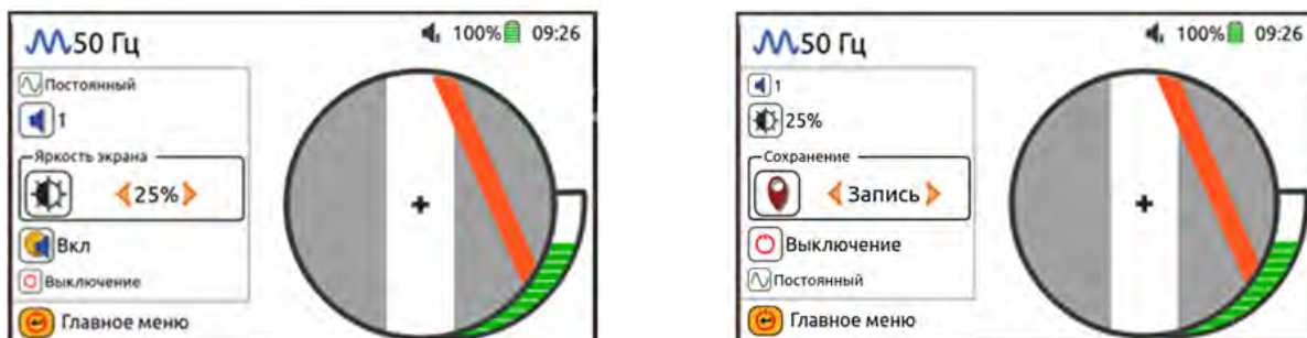
Рисунок 4.3. «Быстрое меню» приемников АП-019.4 и АП-019.5.
