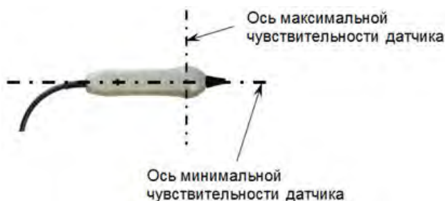
Рисунок А.2. Оси чувствительности датчика MED-127.
