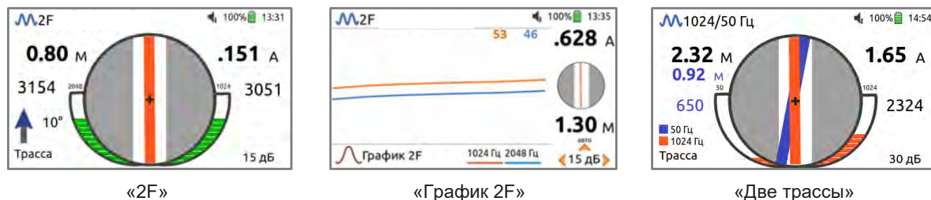
Рисунок 3.2. Виды индикации в двухчастотных режимах.
