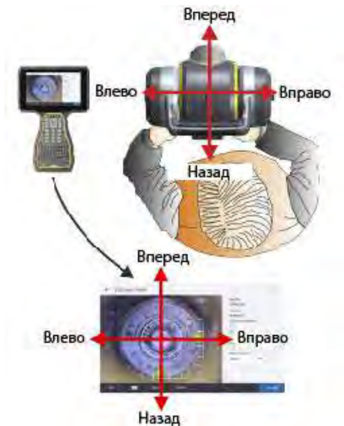
Установка над точкой с помощью камеры отвеса
