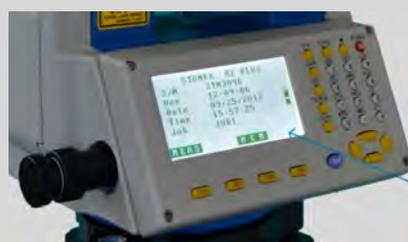
Двухсторонняя панель с клавиатурой и LCD дисплеем высокого разрешения
