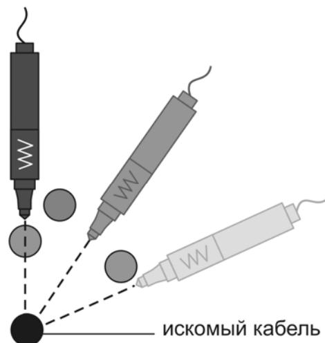
Рисунок 4.5.2 - Минимум уровня сигнала при пересечении осей минидатчика и искомого кабеля
