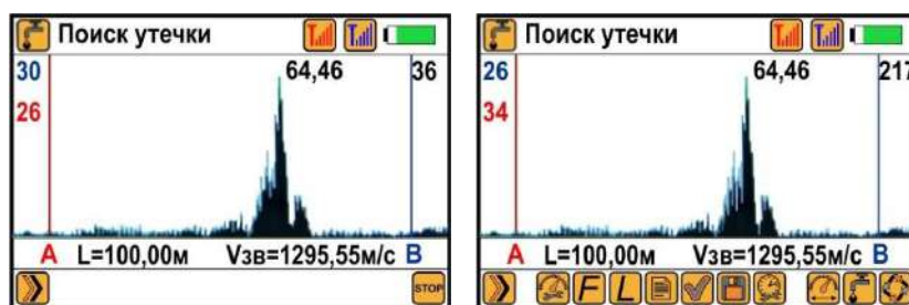
Рисунок 11 Окно «поиск утечки, корреляционная функция». Слева - в процессе проведения последовательности измерений, справа - после остановки измерений
