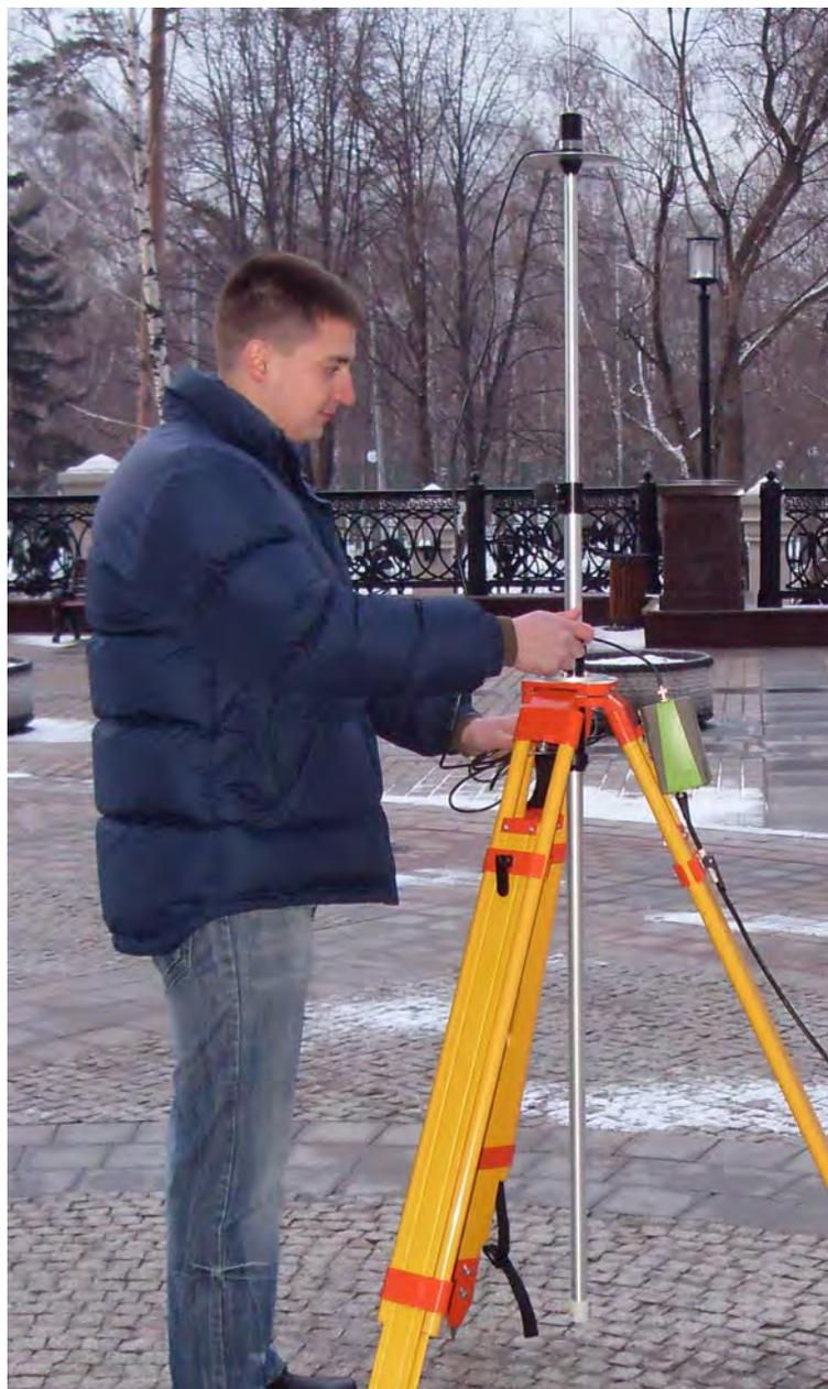
Рисунок 3-1. Пример установки НРТ435ВТ
