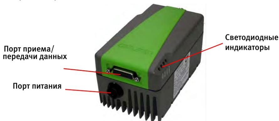
**Рисунок 1-2. Передняя панель НРТ435ВТ**
