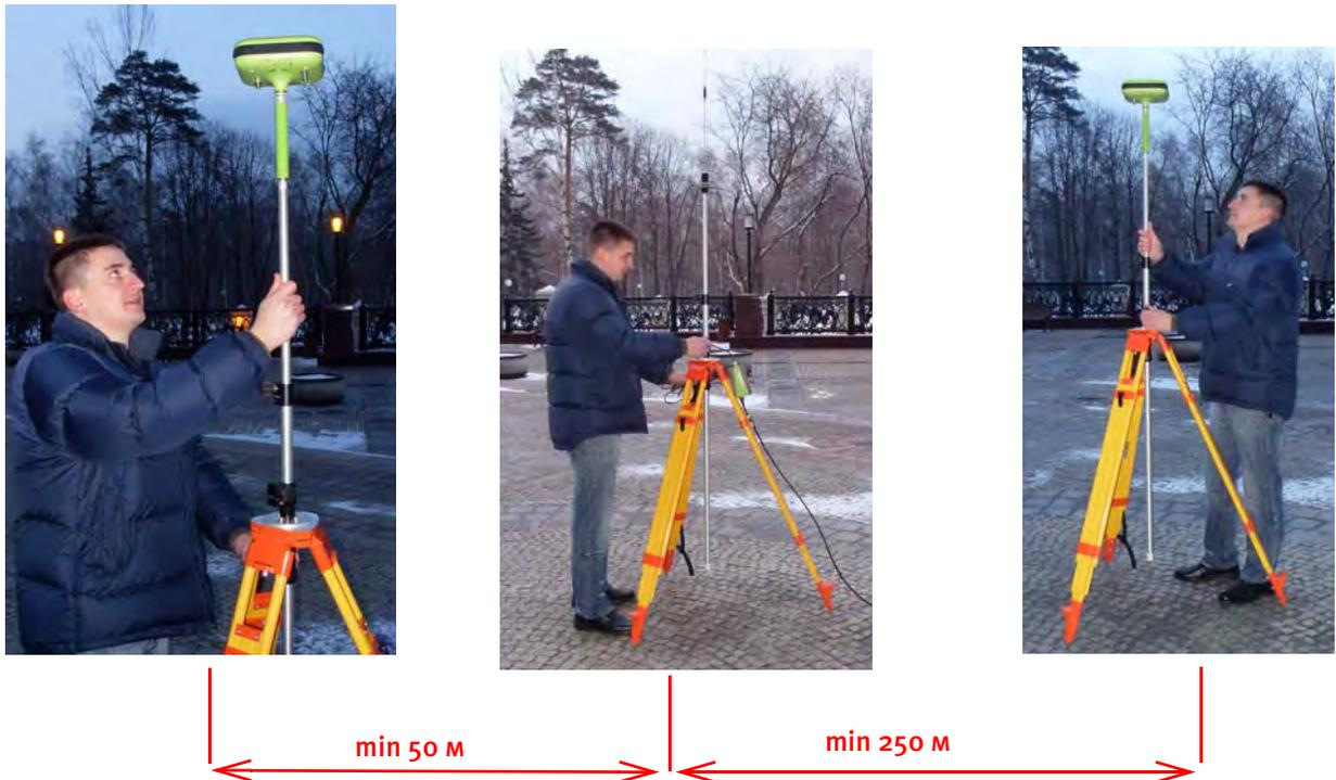
TRIUMPH-1 В КАЧЕСТВЕ БАЗЫ    НРТ435ВТ В КАЧЕСТВЕ ПОВТОРИТЕЛЯ    TRIUMPH-1 В КАЧЕСТВЕ РОБЕРА
