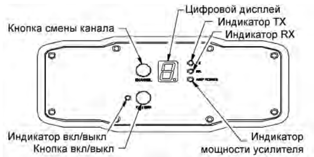
Рисунок 4 - Передняя панель радиомодема HPB 450
