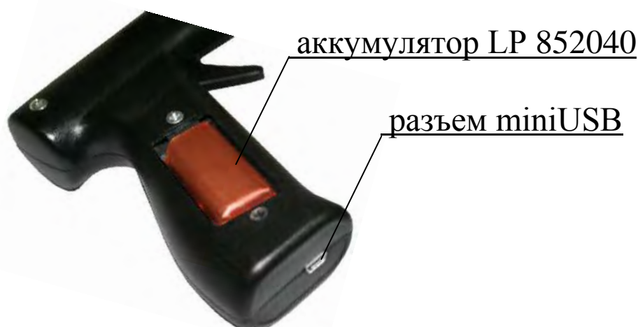
Рисунок 1.2 – Вид рукояти преобразователя
