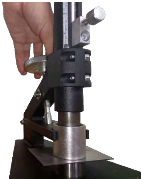
Рисунок 2.2 – Установка образца на наковальню
