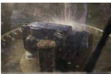
Мы проводим жёсткие испытания нашей продукции, чтобы обеспечить длительную работостойкость оборудования даже в самых тяжёлых рабочих условиях. Тахеометры серии iM тщательно обследуются на соответствие требованиям пыле и водозащиты. Помимо этого, проводятся испытания на защиту от вибрации, устойчивость к падению, воздействие разных температур и влажности. Также, проводятся тесты на точность измерения расстояний и углов, точность нивелирования и настройки системы наведения.
