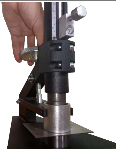
Рисунок 2.4 – Установка образца на наковальню
