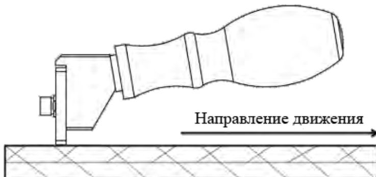
Рисунок 2.1 – Нанесение разрезов на покрытие
