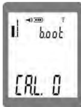
1. В данном режиме значение измерения может быть скорректировано в пределах  $\pm 7$  мм. Короткое нажатие на кнопку ON (иконка) позволяет настроить значение.
