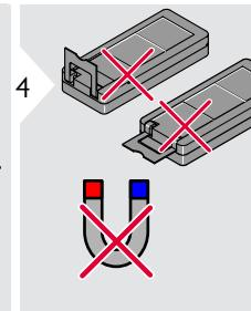
Проверьте, не развернута ли многофункциональная позиционная скоба. Прибор не должен находиться рядом с магнитом.
