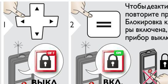
Чтобы деактивировать, повторите процедуру. Блокировка клавиатуры включена, когда прибор выключен.
