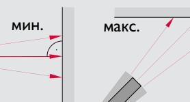
Эта функция используется для измерения диагоналей (максимальные значения) или горизонтальных расстояний до вертикальной поверхности (минимальное значение).
