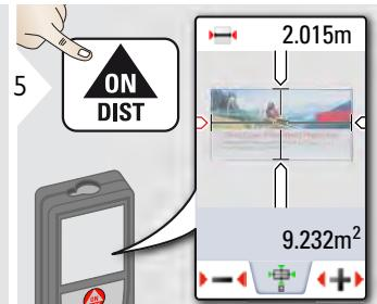
Выбрать стрелки с помощью курсорных клавиш, или нажав на сенсорный экран, и выберите нужные значения с помощью сенсорных клавиш. Рассчитана соответствующая площадь.
