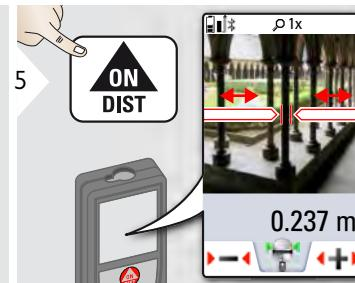
Выбрать стрелки с помощью курсорных клавиш, или нажав на сенсорный экран, и выберите нужные значения с помощью сенсорных клавиш. Рассчитан соответствующий диаметр.
