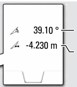
Включен угол между двумя точками
