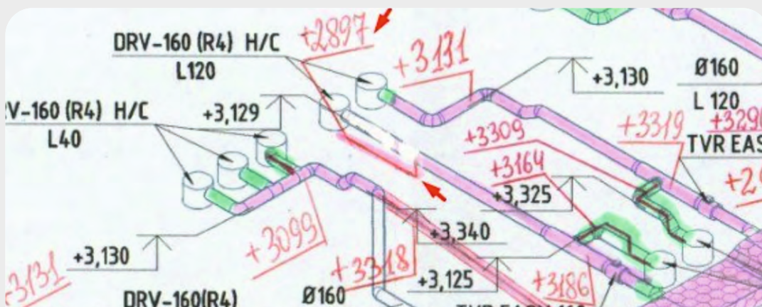
После монтажа системы вентиляции выяснилось, что некоторые воздухораспределители расположены не по проекту, а с некоторыми отклонениями (по высоте или в плане)
