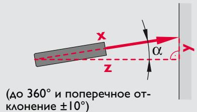
**Измерение угла Smart**
