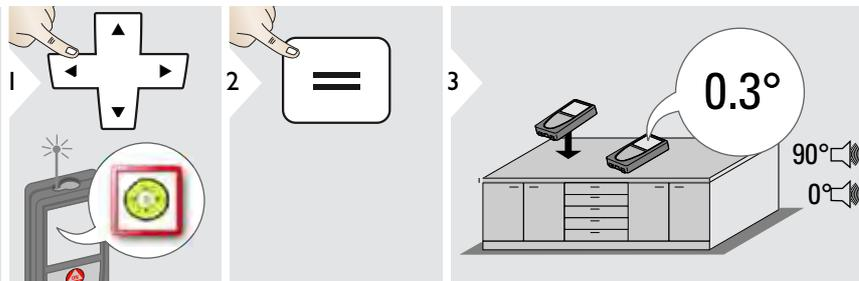
**i** Отображает отклонения на 360° с поперечным отклонением в +/- 10°. Прибор подает сигнал при углах 0° и 90°. Идеально подходит для регулировки горизонтали или вертикали.
