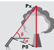
Направьте лазер на верхние точки и отслеживание угла/высоты начнется автоматически.
