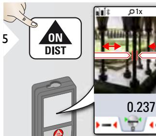
Выбрать стрелки с помощью курсорных клавиш, или нажав на сенсорный экран, и выберите нужные значения с помощью сенсорных клавиш. Рассчитан соответствующий диаметр.
