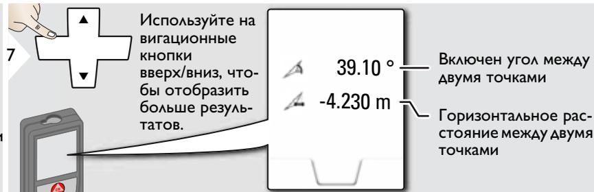
**1** Косвенное измерение расстояния между 2 точками с дополнительными результатами. Идеально подходит для измерения длины или наклона крыши, высоты купола на крыше,...
