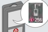
**Непрерывное измерение / измерение минимального-максимального расстояния**
