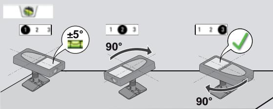
Дважды повернуть прибор по направлению часовой стрелки на  $90^\circ$ . Следуйте инструкциям на дисплее. Выравнивание завершено после появления иконки "OK" на дисплее.
