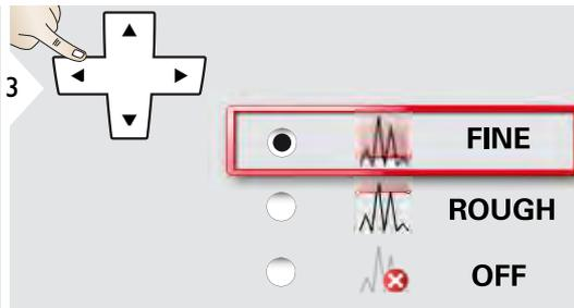
Выбрать чувствительность выравнивания, требуемую для некоторых функций измерения. "FINE" значит, что выравнивание прибора чувствительно к любым небольшим вибрациям. Выберите "ROUGH" при работе в жестких условиях на стройплощадке с большим количеством нагрузок и вибраций. В этом случае точность уменьшается в зависимости от движения.
